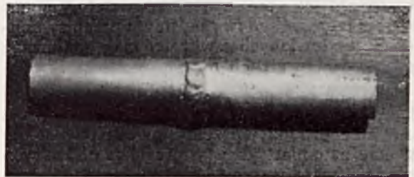
Rys. 2. Spawana rurka z antikorodal.
