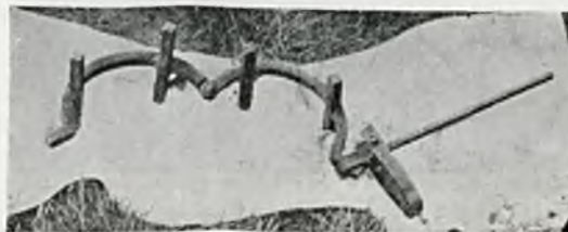
Rys. 61. Uchwyt do centrowania rur wykonany z prętów
