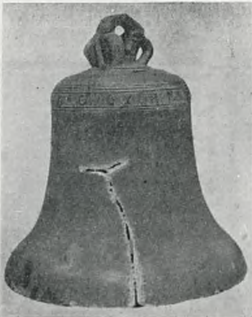
Rys. 11. Dzwon wagi 1800 kg. naprawiony za pomoca spawania. Długość spoiny — 1670 mm, grubość ścianek — 40 — 100 mm; zużycie spoiwa — 58 kg.; czas spawania — 16 godzin.
