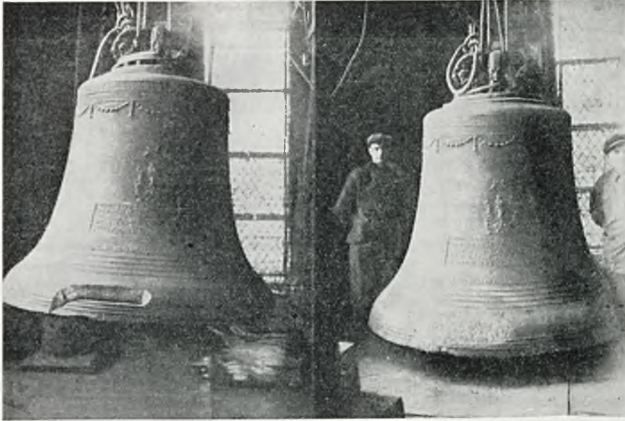
Rys. 10. Dzwon wagi 6 tonn przed i po naprawie zapomocą lutospawania. Przygotowania — 8 dni pracy 2-ch robotników; lutospawanie — 4 godz.; zużycie materiału: acetylen — 30 m 3 , tlen — 35 m 3 , spoiwa — 38 kg., węgiel drzewny — 500 kg.
