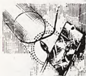
Rys. 69. Stosowanie lusterka przy spawaniu w niedostępnych miejscach.
