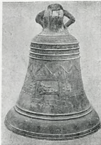
Rys. 8. Korona dzwonu wagi 700 kg naprawiona za pomocą lutowania w ciągu 8 godz. Zużycie materiału: acetyleny — 10 m 3 , tlenu — 12 m 3 , Bronzytu — 5,5 kg.
