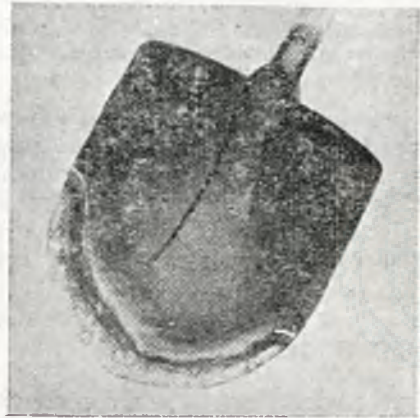
Rys. 14. Łopata napawana metalem twardym.
