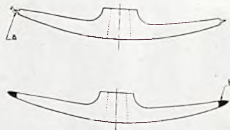
Rys. 9. Napawanie Alchromem oskardu nowego.
