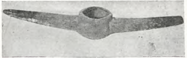
Rys. 13. Kilof napawany metalem twardym.
