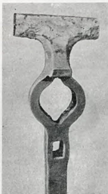
Rys. 22. Imadło z rys. 21 po naprawie przy użyciu drutu „PMS”.
