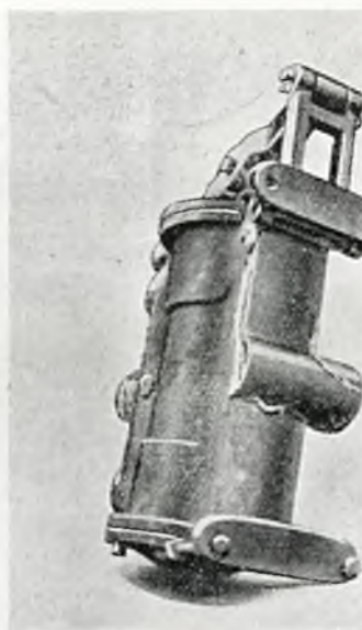
Rys. 10. Pompa wodna pęknięta wskutek mrozu.
