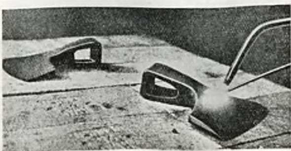
Rys. 18. Siekiera naprawiona zapomocą spawania.
