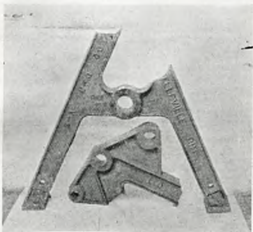
Rys. 8. Żeliwna rama maszyny rolniczej przed naprawą.
