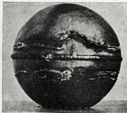
Rys. 16. Boja morska wykonana ze stali nierdzewiejącej 18/8 spawana acetylenem, zniszczona wskutek korozji międzykrystalicznej w metalu spawanym (spoina nietknięta).
