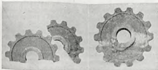
Rys. 16. Żeliwne koło zębate żniwiarki naprawione zapomocą spawania.
