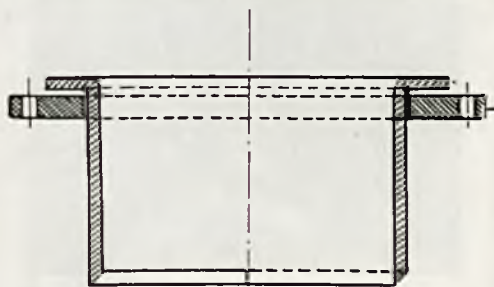
Rys. 7. Ukosowanie krawędzi króćca o \varnothing pow. 100 mm.
