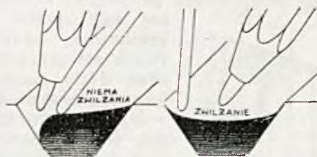
Rys. 4 i 5. Niewłaściwe (na lewo) i właściwe (na prawo) położenie palnika.
