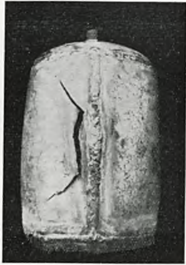
Rys. 28. Wyniki próby na ciśnieniu zbiornika z blachy cynkowanej, wykonanego zapomocą lutowspawania w wytwórni Tow. Akc. Perun. Pęknięcie poza spoiną.
