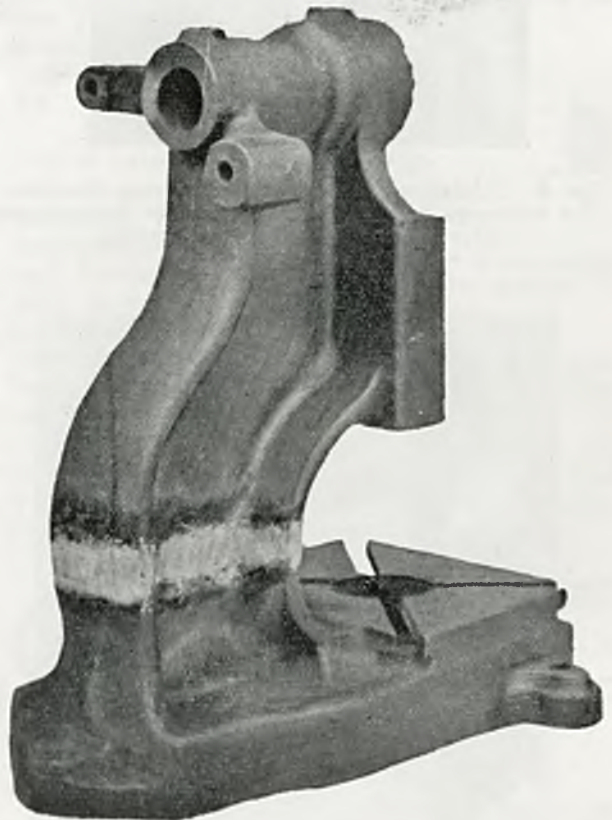
Rys. 6. Rama prasy naprawiona zapomocą lutospawania. Przygotowanie (ukosowanie) - 6 godz.; spawanie - 1.5 godz. (Włochy).
