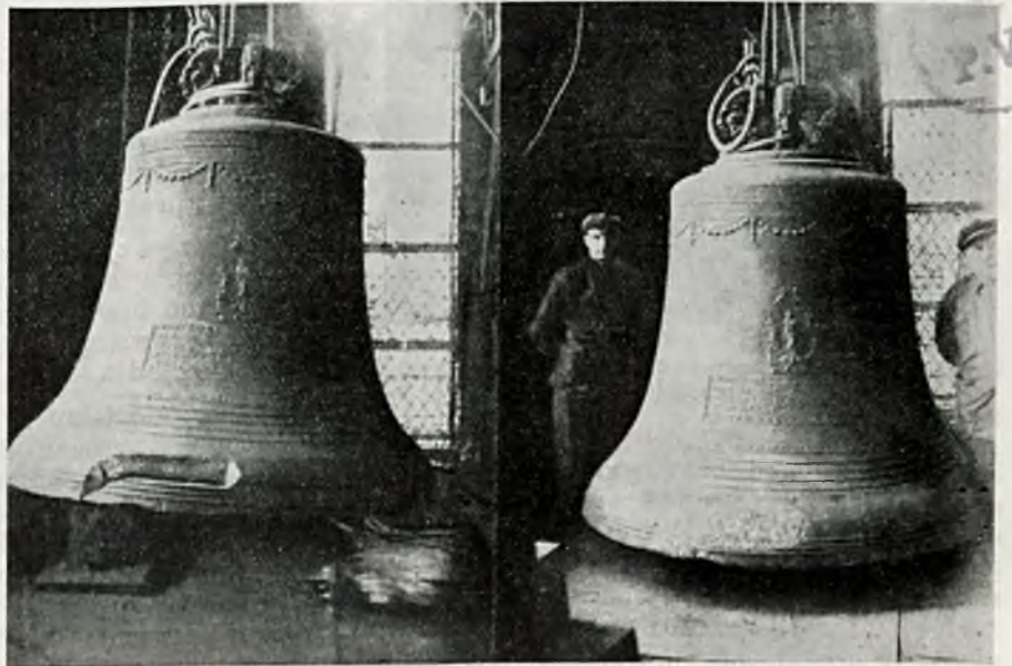
Rys. 36. Dzwon wagi 6000 kg przed i po naprawie zapomocą lutospawania. Długość pęknięcia — 95 cm, szerokość 10 cm, grubość 17 cm. Zużycie drutu do lutospawania — 38 kg. Czas spawania: 4 godz.
