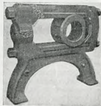
Rys. 2. Rama żeliwna naprawiona zapomocą lutospawania.
