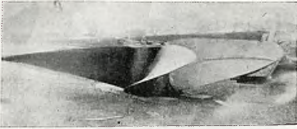
Rys. 34 i 35. Śruba z brązu wagi kilku tonn, pęknięta na długości 50 cm. jak to widać na lewym zdjęciu, została naprawiona zapomocą lutospawania w ciągu 1½ godz. Grubość spoiny: (12 — 50 mm).
