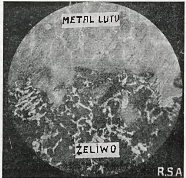
Rys. 35. Połączenie lutu z żelivem w powiększeniu.
