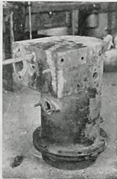
Rys. 37 i 38. Naprawa motoru zapomocą lutospawania. Widok przed i po spawaniu. Do naprawy zużyto 1,5 m 3 tlenu, 6 kg karbidu, 1 kg drutu „Bronzyt”, 0,1 kg pasty Redol i 0,05 kg proszku „Alfin”.
