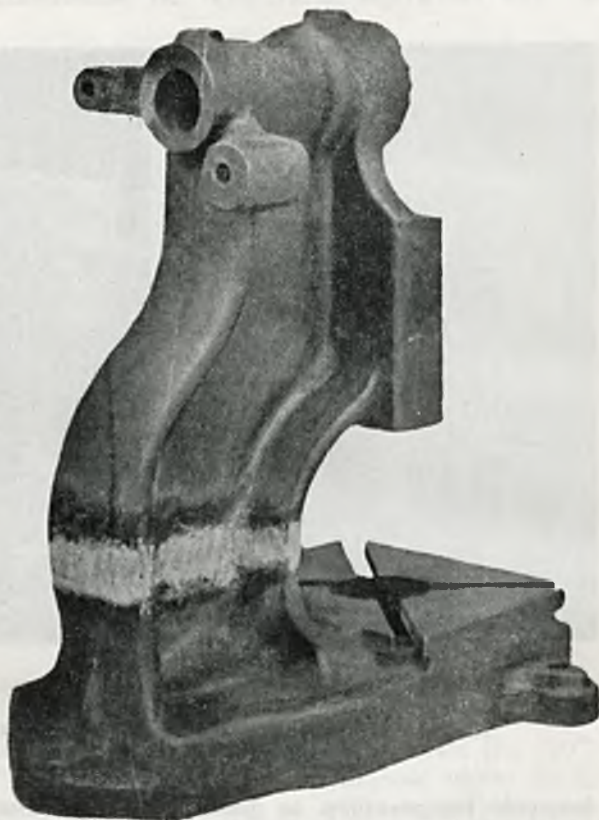
Rys. 42. Rama prasy naprawiona zapomocą lutowania, wagi 69 kg. Palnik 1000 litr. Spożycie tlenu 3,8 m 3 , acetyleny - 3,5 m 3 , drutu - 1,5 kg, proszku - 100 gr. Czas przygotowania (ukosowanie) - 6 godz., czas spawania - 1,5 godz. (Włochy).
