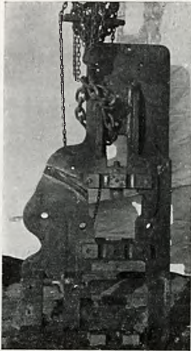
Rys. 26 i 27. Zukosowane pęknięcie na ramie gwoździarki i rama naprawiona. Zużyto: pałeczek żeliwnych — 3 kg, proszku — 250 gr, tlenu — 3,5 m 3 i karbidu — 14 kg. Czas spawania — 4½ godz. Do podgrzania zużyto 20 kg węgla. (Z praktyki Sp. Akc. Perun).
