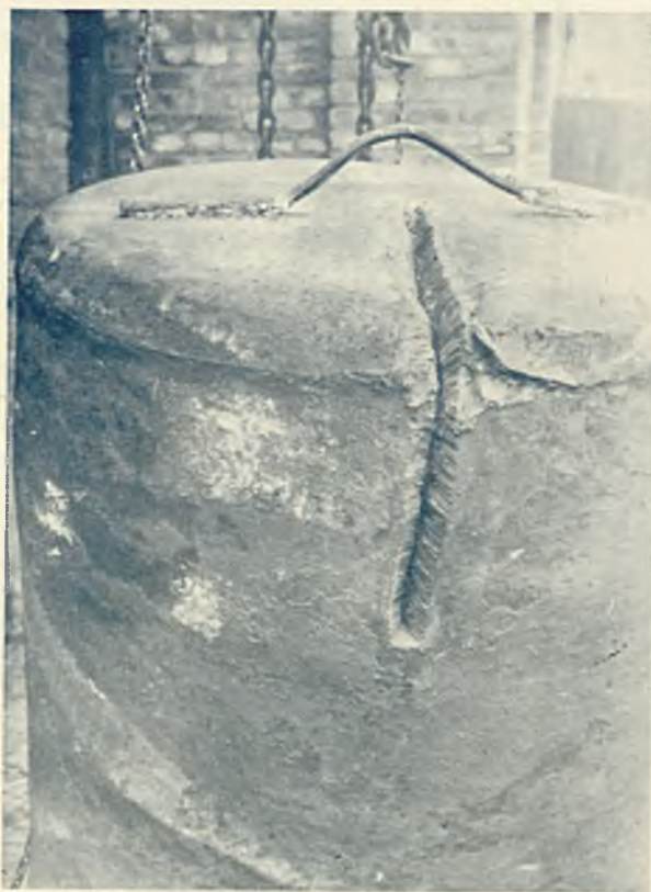
Naprawa grubościennego kotła żeliwnego zapomocą spawania (z praktyki Warszt. Sp. Akc. Perun)
