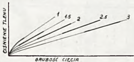
Rys 1. Ciśnienie tlenu do cięcia w zależności od grubości materiału.
