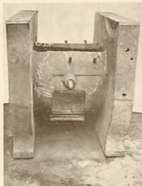
Naprawa mieszadła do gliny (odlew żeliwny), wykonana zapomocą spawania acetylenowego (do art. na str. 141).
