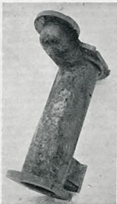
Rys. 2. Cylinder po naprawie zapomocą spawania acetylenowego.
