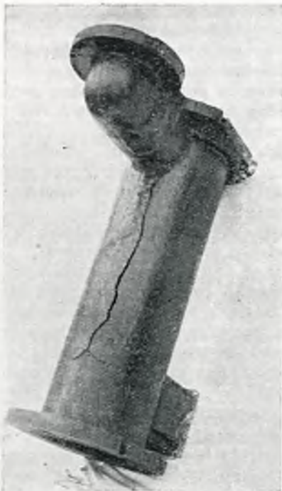
Rys. 1. Cylinder przed naprawą.
