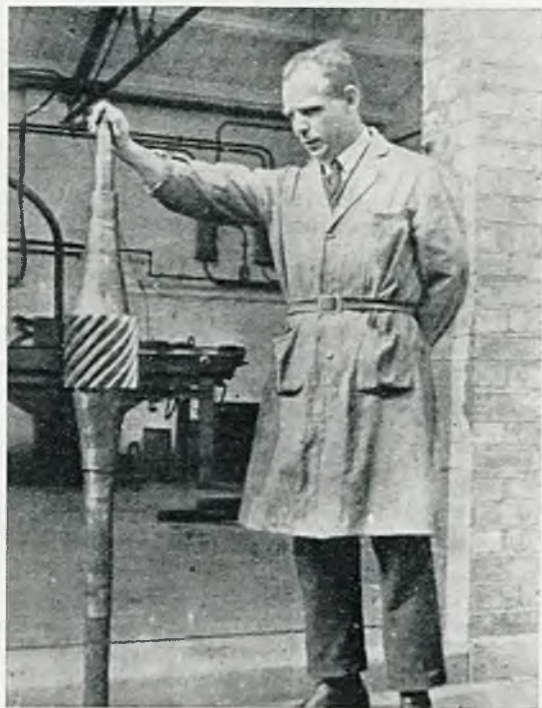
Rys. 9. Hartowany wał z kołem śrubowym. (The Welding Journal, Nor., V, 1930).
