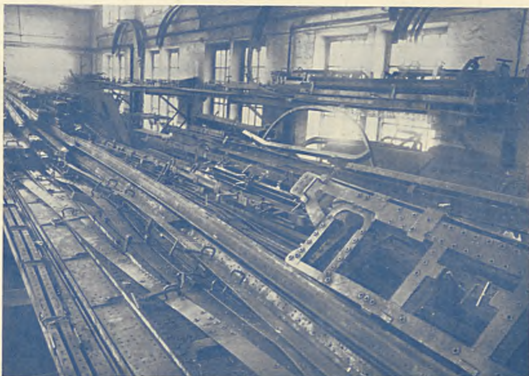
Skład przyrządów spawanych do budowy wagonów w Zakładach Tow. „Lilpop Rau i Loewenstein” w Warszawie (do art. na str. 98)
