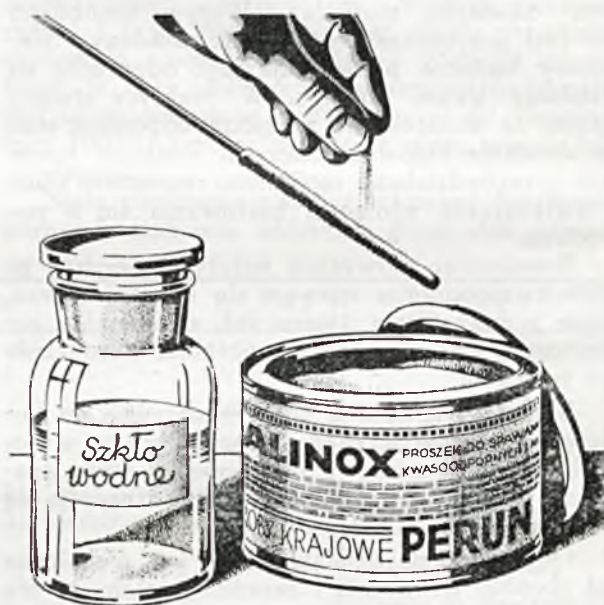
Rys. 6. Pokrywanie drutu szkłem wodnym i proszkiem.
