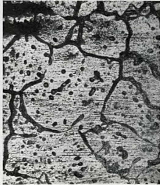
Rys. 27. Struktura spoiny stopu aluminiowego z domieszką miedzi.
