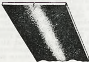
Rys. 5. Blacha przygotowana do spawania. Krawędzie od dołu pokryte są szkłem wodnym i proszkiem (por. rys. 6).
