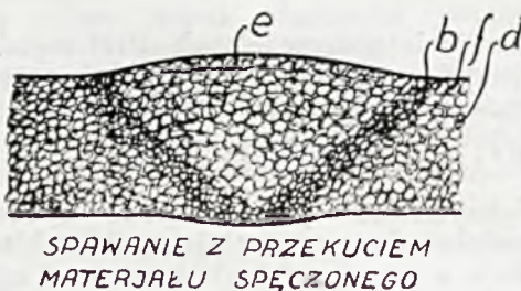
Rys. 9. Struktura różnie obrabianych spoin aluminium, wykonywanych drutem z czystego aluminium. a — spoina, b — strefa metalu stopionego, c — strefa metalu przegrzanego, d — struktura niezmieniona, e — spoina ulepszona, f — strefa rekrytalizacji.
