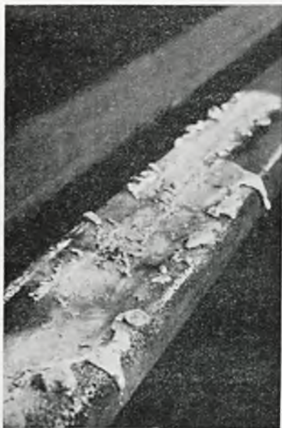
Rys. 8. Rak szyny o długości 500 mm, szerokości 20—30 mm, głębokości 2—3 mm, po wytopieniu.
