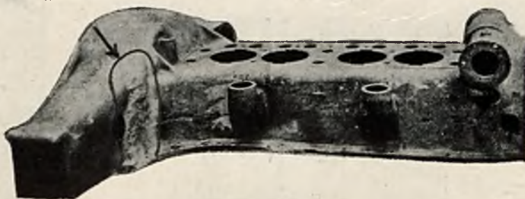
Rys. 12. Karter aluminiowy silnika samochodowego „Ursus” po naprawie.
