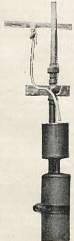
Rys. 3. Doprowadzenie wody do bezpiecznika.
