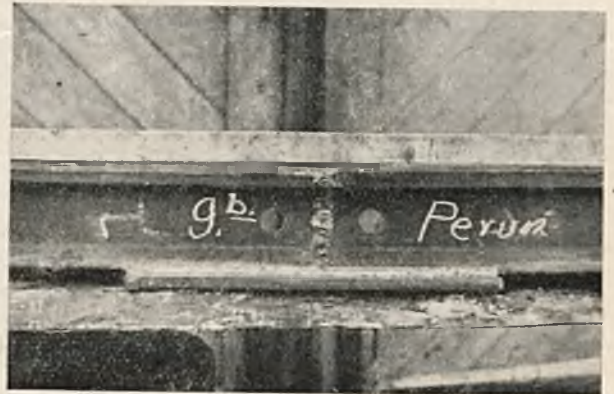
Złącze z podkładką spawane łukiem el., wytrzymało 4-krotne uderzenie bijakiem 450 kg. z wysok. 4 m bez pęknięcia, przy ugięciu 5 mm.
