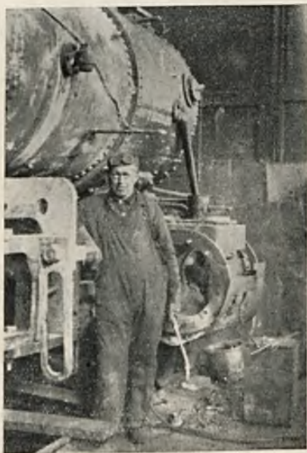
Rys. 1. Najnowszy sposób naprawy cylindrów parowozowych: lutowanie palnikiem acetylenowo-tlenowym, przy użyciu brzozy „Tobin” (koleje kanadyjskie).
