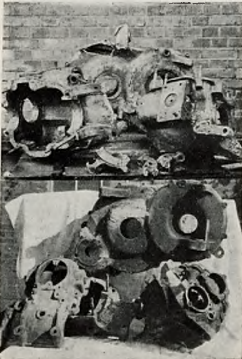
Rys. 6. Uszkodzone (u góry) i naprawione (u dołu) różne odlewy aluminiowe.
