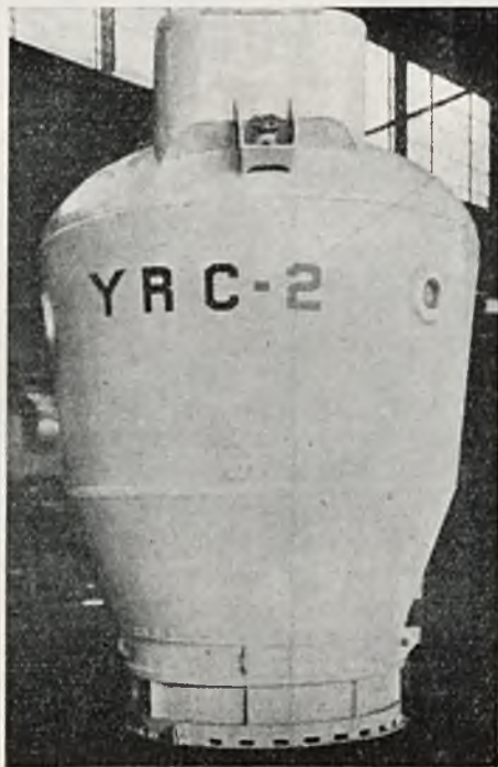
Rys. 9. Całkowicie spawana komora do ratowania załogi zatopionych łodzi podwodnych.
