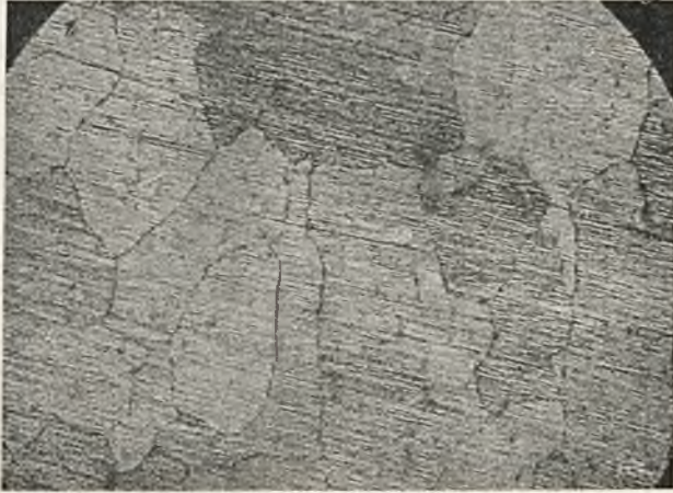
Rys. 3. Budowa spoiny niklowej (100x).
