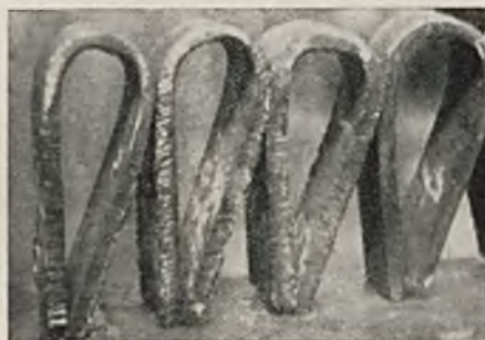
Rys. 160. Charakterystyczny kształt blach spawanych w środku, po próbie na zginanie.
