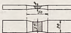
Rys. 2. Próbką do rozrywania obrobioną.
