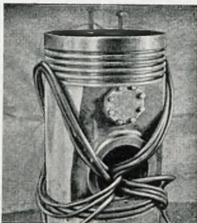
Rys. 49. Widok badanego cylindra wraz z nawiniętymi przewodami.
