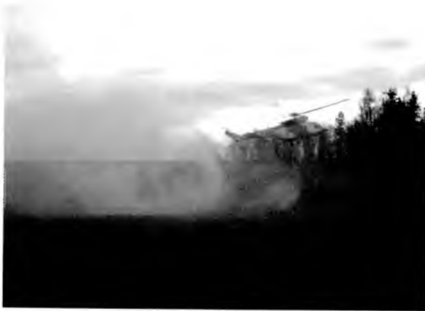
Rys. 8. Struktura strumienia zawirnikowego podczas występowania zjawiska ETL
