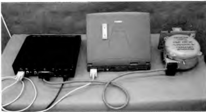
Rys. 6. System Black Box – widok połączeń czytnika z kasetą oraz komputerem
