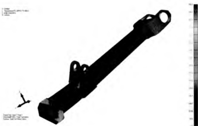
Rys. 8. Przykładowa wizualizacja wyników analizy detalu podwozia przy pomocy MES (rys. ILOt)
