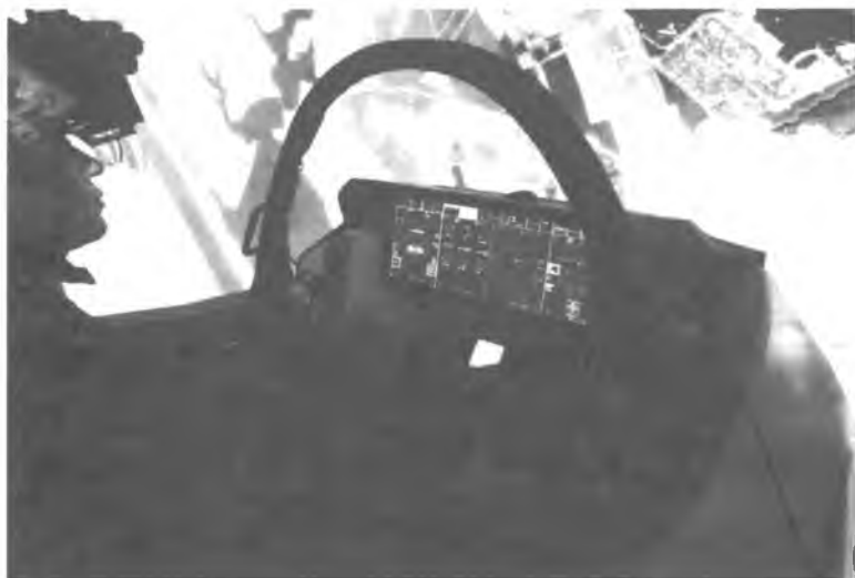
Rys. 10. Wizualizacja w systemie „dome simulator” w symulatorze dla samolotu F-35 (źródło: Lockheed Martin)
