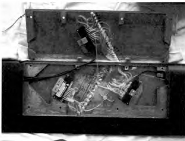
Rys. 5. Czujniki ciśnienia ESP-16HD umieszczone wewnątrz modelu (fot. S. Podgródny, ILOT)
