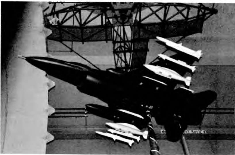
Rys. 5. Model samolotu F-16 z zestawem podwieszonych w skali 1:4.5
