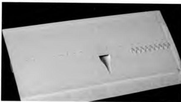
Rys. 3. Fragment pokrycia kłapy szybowca Diana-2 z pneumatycznym systemem turbulizacji
