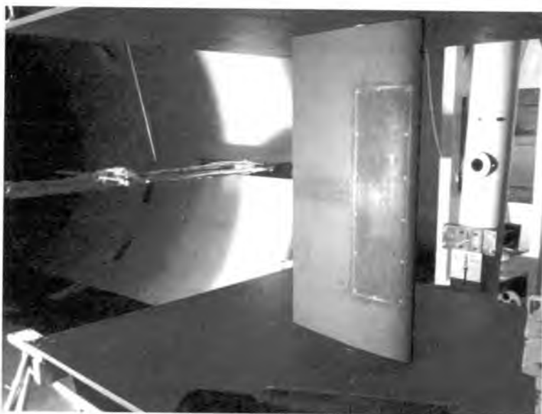
Rys. 3. Model profilu NACA 0012 w Tunelu Małych Prędkości T-1
