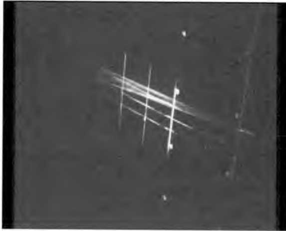
Rys. 4. Wizualizacja wiru wytwarzanego przez konwencjonalne strumieniowe generatory wirów
