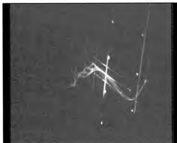
Rys. 8. Wizualizacja opływu profilu NACA 0012 z konwencjonalnymi strumieniowymi generatorami wirów dla \alpha = 18.4^\circ
