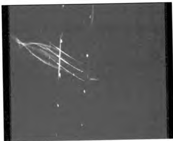
Rys. 11. Wizualizacja opływu profilu NACA 0012 z samozasilającymi się strumieniowymi generatorami wirów dla M = 0.075 i \alpha = 15.7^\circ
