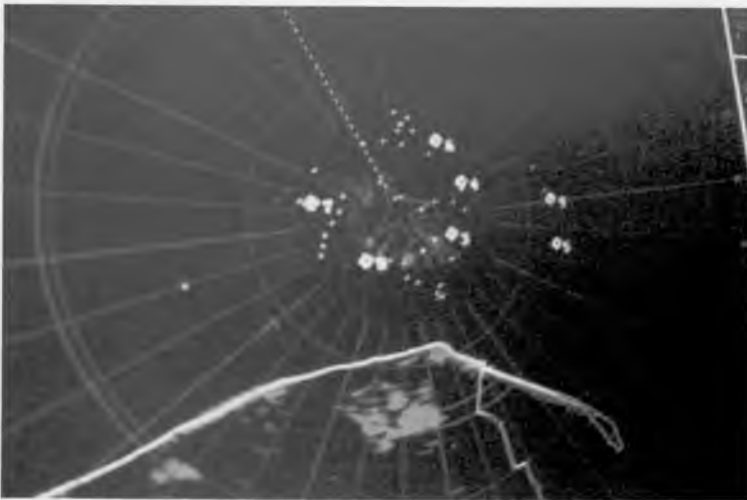
Rys. 3. Pokrywanie się wizji pierwotnej (kolor żółty) ze zobrazowaniem linii syntetycznej
