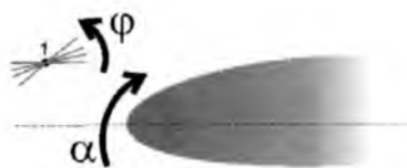
Rys. 2. Idea obrotowego slotu do sterowania opływem profilu
