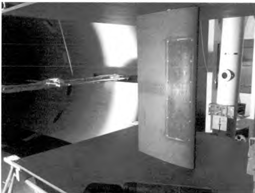
Rys. 3. Model profilu NACA 0012 w Tunelu Małych Prędkości T-1.
