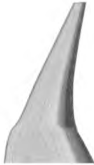
Rys. 18. Rozkład ciśnień w narożu skrzydło-winglet z rys.7 po projektowaniu szczegółowym metodą odwrotną
