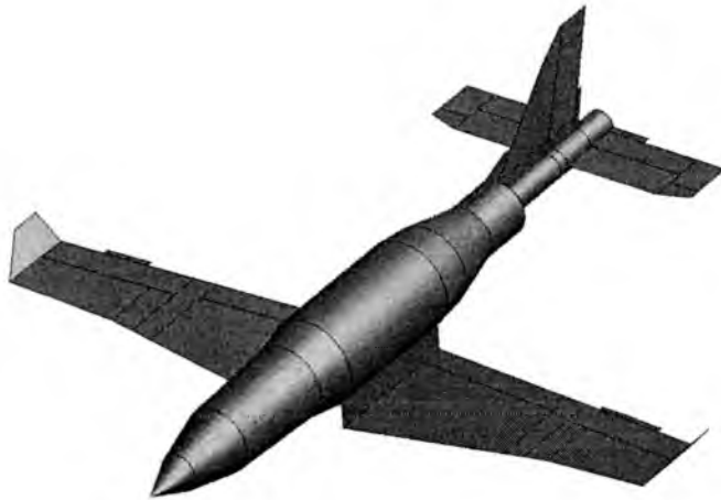
Rys. 18. Model samolotu PZL-130 TC II do wyznaczania aerodynamiki niestacjonarnej w analizie flutteru. Wyróżnione zostały aerodynamiczne panele powierzchniowe oraz kadłubowe elementy bryły smukłej. Dla przejrzystości rysunku nie pokazano elementów interferencyjnych
