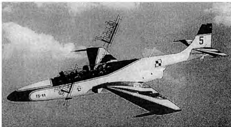
Rys. 20. Katapultowanie modelowego systemu fotel+pilot z TS-11 „Iskra”
