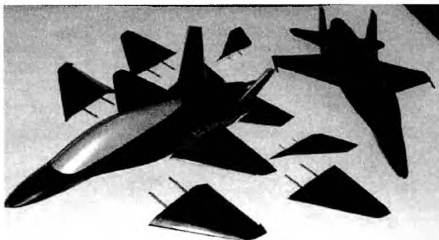
Rys. 12. Modele samolotu "Bielik" używane do badań w tunelu aerodynamicznym
