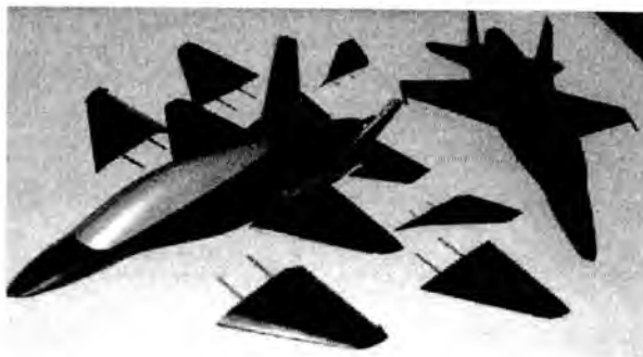
Rys. 8. Modele aerodynamiczne samolotu „Bielik”: wstępny (z prawej) oraz szczegółowy (z lewej)
