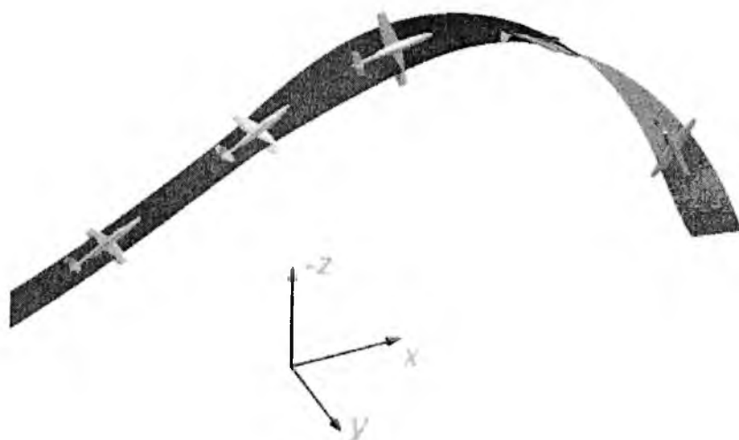
Rys. 16. Wyniki symulacji numerycznej lotu samolotu TS-11 „Iskra” z silnikiem SO3 po wystąpieniu oblodzenia w trakcie wznoszenia
