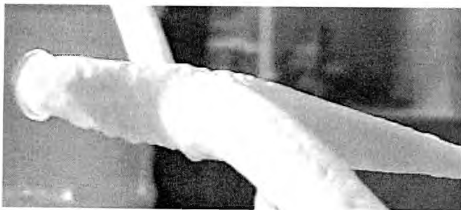
Rys. 2. Charakterystyczne podkowiaste zeszklenie wokół noska profilu (prosty płat, \alpha = 5^\circ ) ostatnia faza procesu, \alpha = 5^\circ )
