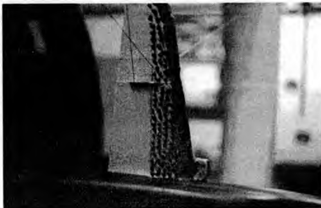
Rys. 15. Szron na powierzchni skrzydła + warstwa lodu na krawędzi natarcia+ sople na górnej powierzchni skrzydła
