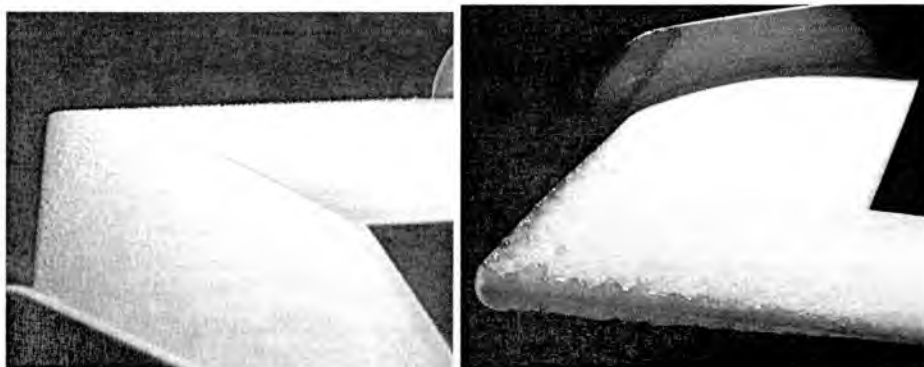
Rys. 3. Bardzo wczesna (15 sek.) i pośrednia (kilkuminutowa) faza symulacji przy zerowym kącie natarcia. Widoczne na lewym zdjęciu małe grudki lodu szybko zamieniają się w przejrzyste oblodzenie szkliste krawędzi natarcia – zdjęcie prawe.
