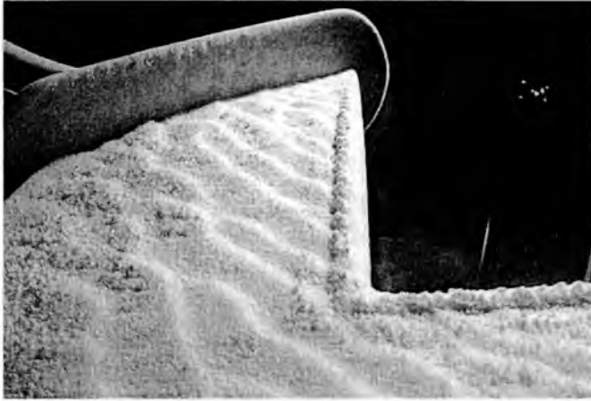
Rys. 8. Wyraźny efekt oderwania widoczny na spływowej części płata
