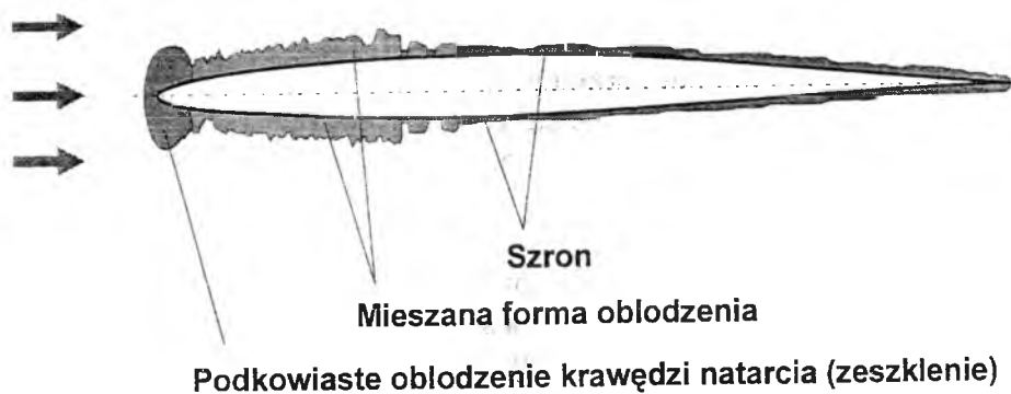
Rys.3. Struktura oblodzenia cienkiego profilu przy małych kątach natarcia
