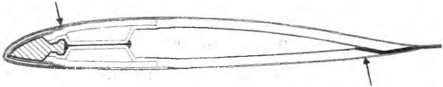
Rys.4. Przekrój fragmentu łopaty oraz miejsca przyłożenia impulsów wysokoprądowych.
