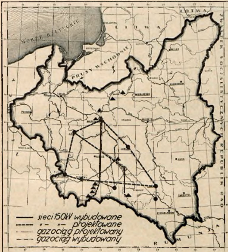
Rys. 9. Sieć krajowa elektryczna i gazowa.
