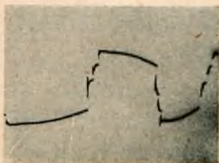
Rys. 19. Krzywa napięcia na kondensatorze 110 \mu\mu\text{F} połączonym w szereg z iskiernikiem (rys. 16). Oscylacje szybkozmienne są widoczne pod postacią pionowych kresiek po każdym skoku (retuszowanych). Analogiczny oscylogram, ale bez tych kresiek, odnosi się do obwodu z rys. 11 *).
