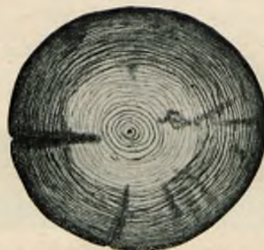
Rys. 7. Schemat przenikania substancji impregnacyjnej w głąb drewna wg. metody osmotycznej.
