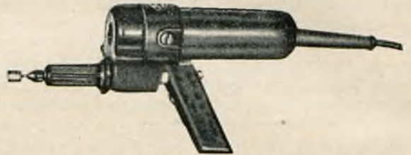
Ryc. 8. Szlifierka elektryczna ręczna US—1 do delikatnego szlifowania wzgl. polerowania krążkami do 14 mm Ø 50 000 obr./min.
