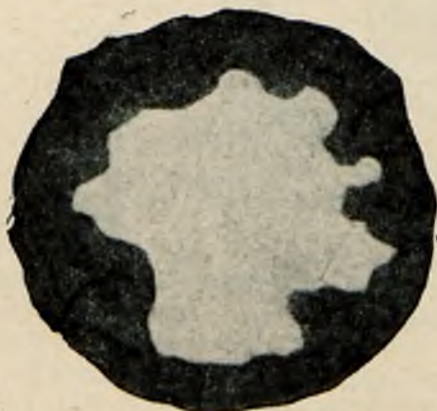
Rys. 6. Przekrój słupa w kilkanaście miesięcy po zastrzykach.
