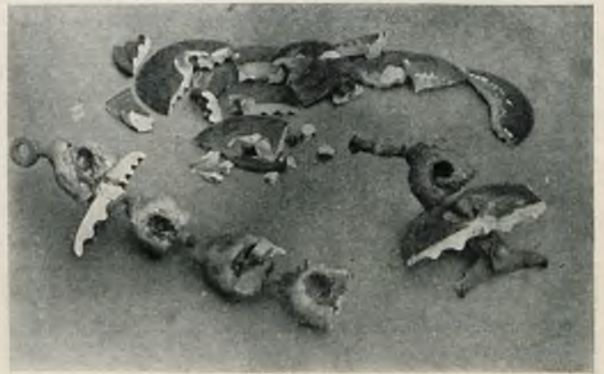
Rys. 8. Kompletnie zniszczony łańcuch izolatorów linii 60 kV (wyraźnie widać prócz rozbić również wytopienia).
