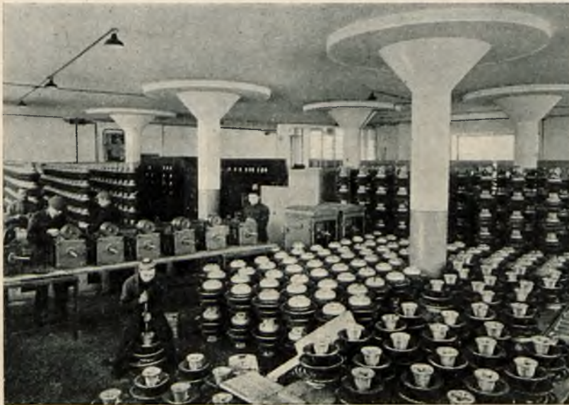
Rys. 5. Montaż odłączników 150 kV.
