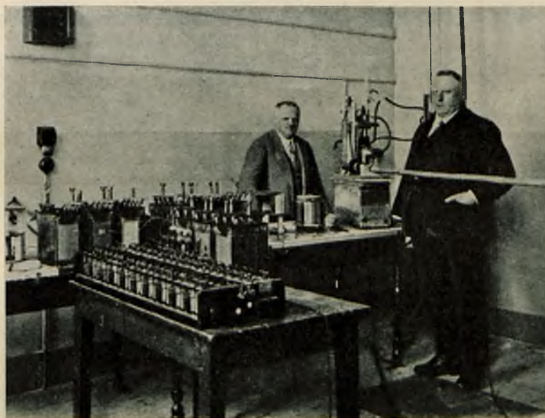
Pomiar stałej dielektrycznej ciekłego helu (Wolfke i Keesom, 1927)
