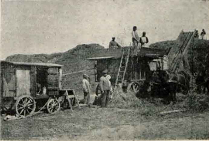
Rys 5. Młócenie zboża zapomocą motoru we wózku.
