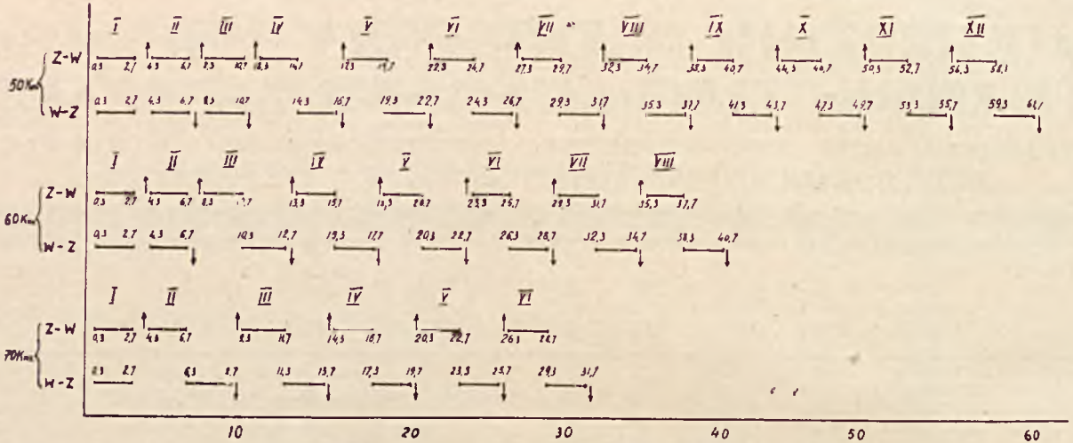
RYS. 12. ROZŁOŻENIE PASM CZĘSTOTLIWOŚCI W KABLACH JAPANEŃSKICH.
