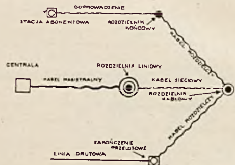
RYŚ. 1. SCHEMAT POŁĄCZENIA STACJI ABONENTOWEJ Z CENTRALĄ TELEFONICZNĄ.
