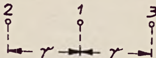
RYS. 71. PRZYKŁAD LINII TRÓJFAZOWEJ NIESYMETRYCZNEJ, W KTÓREJ WSZYSTKIE TRZY PRZEWODY FAZOWE LEŻĄ W JEDNEJ PŁASZCZYŹNIE.
