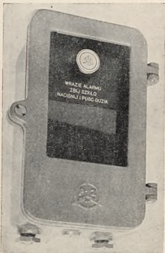
RYS. 9. SYGNALIZATOR TYPU PT (Z WBUDOWANYMI PRZYCISKAMI, LAMPKĄ OŚWIETLENIOWĄ, GNIAZDKIEM TELEFONICZNYM I BUCZKIEM SYGNAŁU ZWROTNEGO).
