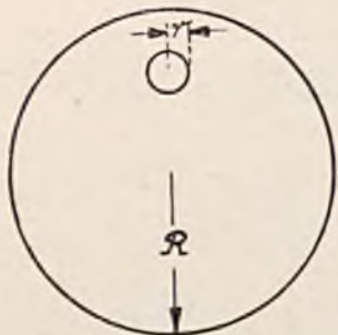
RYS. 49. OBLICZENIE INDUKCYJNOŚCI PĘTLI, UTWORZONEJ Z POJEDYŃCZEGO DRUTU I OSŁONY.
