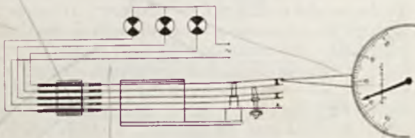
RYS. 4. MIERZENIE NACISKU GÓRNEJ, CZYŃNEJ PARY SPRĘŻYN.
