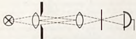
RYŚ. 5. SCHEMAT UKŁADU OPTYCZNEGO ODBIORCZEGO DO FILMÓW DŹWIĘKOWYCH.
