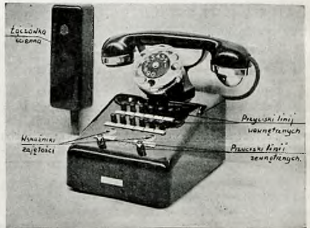
RYŚ. 1. APARAT TELEFONICZNY SZEREGOWY P.Z.T. NA 2 OB. ZEWN. I 12 OBW. WEWNĘTRZNYCH.
