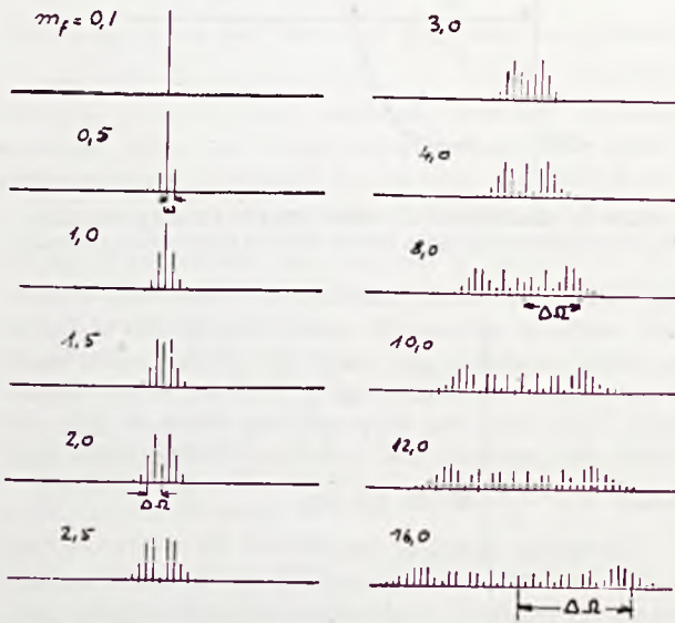
RYC. 9. MODULACJA CZĘSTOTLIWOŚCI. WIDMO CZĘSTOTLIWOŚCI EMITOWANYCH PRZY STAŁEJ CZĘSTOTLIWOŚCI MODULUJĄCEJ f = \frac{\omega}{2\pi} I ZMIENNEJ AMPLITUDZIE MODULUJĄCEJ \Delta \Omega .
