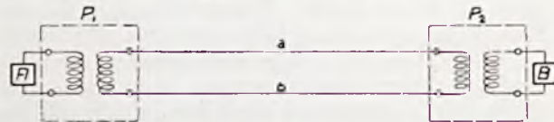
RYŚ. 2. ODDZIELANIE CZĘŚCI OBWODÓW ZAPOMOCĄ PRZENOŚNIKA.
