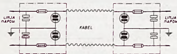
RYŚ. 3. ZABEZPIECZENIE KABLA PRZELOTOWEGO.
